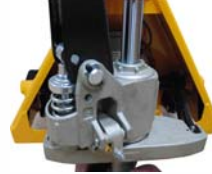
Döküm pompa görünüm
